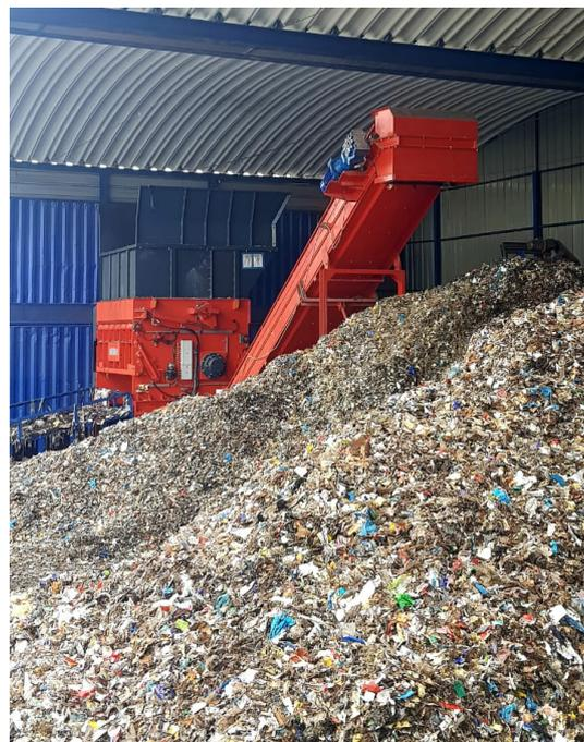
**NOTRE PROCESS INDUSTRIEL PERMET DE RECYCLER ET VALORISER LES DÉCHETS INDUSTRIELS DE NOS CLIENTS JUSQU'ALORS DITS NON RECYCLABLES. GRÂCE À NOTRE BROYEUR CRIBLE VIBRANT ET DIFFÉRENTS SÉPARATEURS (AÉRAULIQUE, OPTIQUE ET MAGNÉTIQUE) NOUS SOMMES EN CAPACITÉ DE TRAITER 40 000 TONNES DE DÉCHETS PAR AN DONT 80% SONT RECYCLÉS ET VALORISÉS.**
